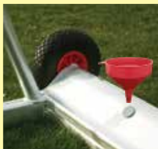
Protizávaží navařeno plní se suchým křemičitým pískem
